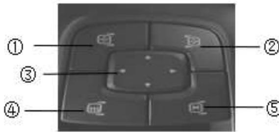
① - Кнопка регулировки левого зеркала заднего вида
