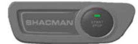
Нажатие на кнопку для переключения в режим OFF: в режиме ON при однократном нажатии на кнопку СТАРТ/СТОП индикатор на кнопке погаснет, автомобиль переходит в режим OFF.
