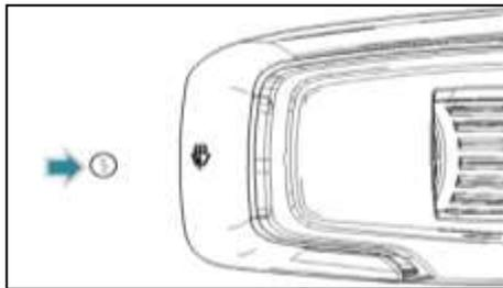
Если нажать на кнопку ⑤ по направлению к оси рычага (с максимальной продолжительностью 0.9 секунд), то произойдет цикл распыления стеклоомывателя и работы стеклоочистителей.
