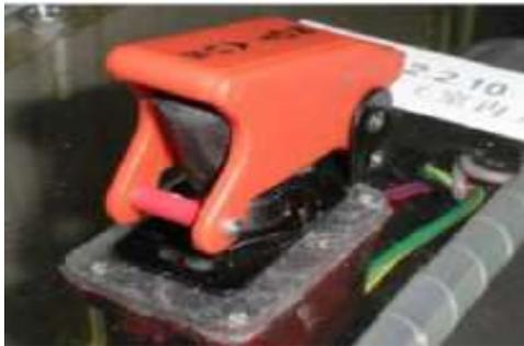
*Рабочее состояние переключателя S2/S3 в процессе движения*
