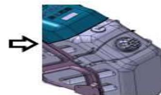
*Установить на место крышку бака раствора мочевины и защитную накладку*
