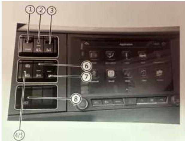
1 - Переключатель блокировки межколесного/межосевого дифференциала
