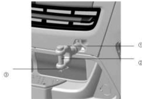
При необходимости буксировки в передней части автомобиля следует установить буксировочный крюк. Отверстия для установки буксировочного крюка расположены с обеих сторон переднего бампера. Перед установкой буксировочного крюка следует вставить отвертку в паз заглушки на переднем бампере, приподнять заглушку, по часовой стрелке до упора вкрутить буксировочный крюк ①, до тех пор, пока он не будет расположен в горизонтальном положении.
