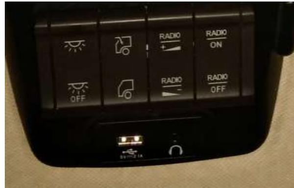
USB-разъем является источником подачи постоянного тока напряжением 5 В, с максимальной мощностью 5 А. Данный разъем предназначен только для подзарядки мобильных устройств, не оснащен функцией цифровой передачи данных.
