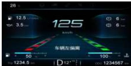
*Отклонение за пределы левой полосы дорожной разметки*
