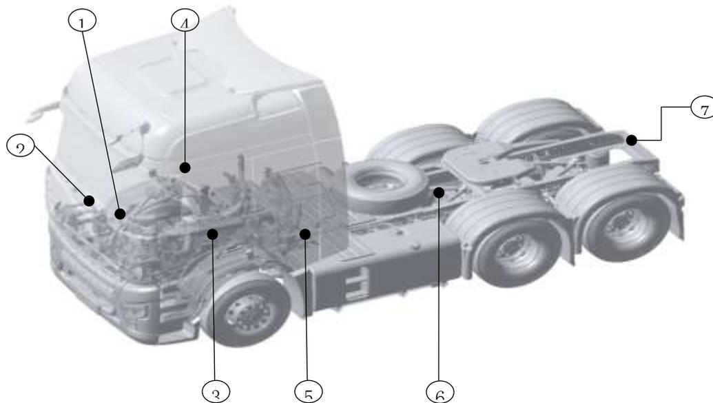
① Идентификационная маркировка транспортного средства (VIN) выгравирована на внешней поверхности лонжерона с правой стороны рамы автомобиля. VIN-код также нанесен на заводской табличке автомобиля.
