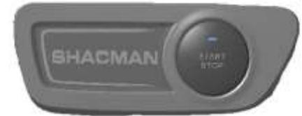
③ Нажатие на кнопку для переключения в режим подачи питания АСС: при однократном нажатии на кнопку СТАРТ/СТОП, на кнопке загорится индикатор оранжевого цвета, автомобиль переходит к подаче питания в режиме АСС (как изображено на рисунке).
