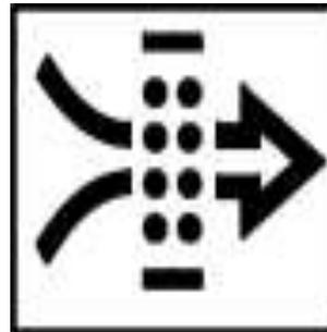
*Предупреждающий сигнал о засоре фильтрующего элемента*
