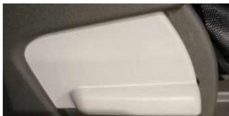
Потянуть за рычаг, отрегулировать угол наклона спинки до необходимого положения при помощи надавливания на поверхность спинки кресла.
