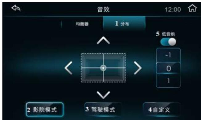
Можно выбрать между двумя предустановленными режимами звучания: «Баланс динамиков» (2) или «Режим вождения» (3).
