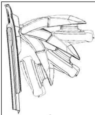
Зеркала заднего вида благодаря их форме можно складывать на 36° относительно корпуса кабины. Если в процессе движения на пути автомобиля имеется некое препятствие, то возможно произвести регулировку положения зеркал заднего вида в соответствии с фактической ситуацией.
