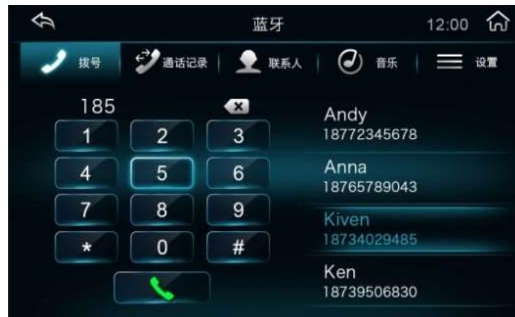
При наборе номера в данном разделе меню отображаются имя и номер телефона вызываемого абонента. Если устройство синхронизовано с телефонной книгой мобильного устройства, то будет отображено имя контакта.
