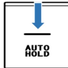
Данная функция находится в активированном состоянии, когда скорость движения автомобиля равна 0. Через 3 секунды автоматически включается рабочая тормозная тормоза. Однако после прохождения заданного времени или когда давление в рабочей тормозной системе находится ниже установленного значения (5.5 Бар), система автоматически переключается на стояночный тормоз.
