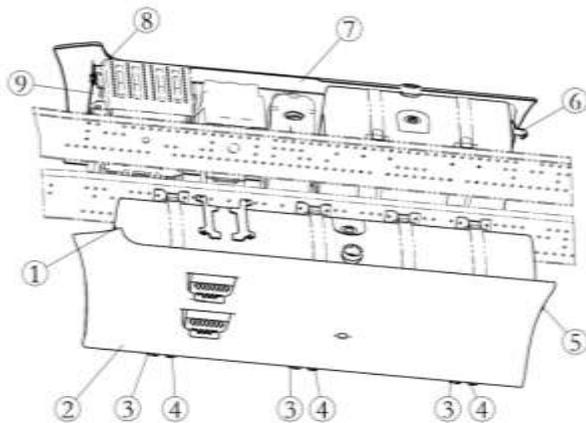
②, ⑦ - левая/правая панель боковой защиты, ①, ③, ④, ⑤, ⑥, ⑧, ⑨ - кронштейны в сборе. Кронштейны ③, ④ крепятся с левой/ с правой стороны в нижней части топливного бака. Кронштейны ①, ⑤ крепятся к задней и передней части левого крыла соответственно. Кронштейн ⑥ крепится к передней части правого крыла. Кронштейны ⑧, ⑨ крепятся к передней части системы обработки выхлопных газов.
