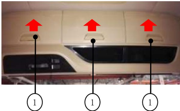
Открыть дверь кабины, нажать на кнопку замка ящика ЗИП, открыть ящик ЗИП.
