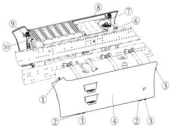
④, ⑧ - левая/правая панель боковой защиты, ①, ②, ③, ⑤, ⑥, ⑦, ⑨, ⑩ - кронштейны в сборе. Кронштейны ②, ③ крепятся с левой стороны в нижней части топливного бака. Кронштейны ①, ⑤ крепятся к задней и передней части левого крыла соответственно. Кронштейны ⑥, ⑦ крепятся к задней части кронштейнов бака мочевины. Кронштейны ⑨, ⑩ крепятся к передней части системы обработки выхлопных газов.
