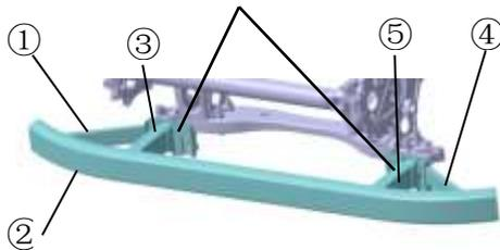
① , ④ - левая/правая наклонная опора защитного устройства передней нижней части кабины,
