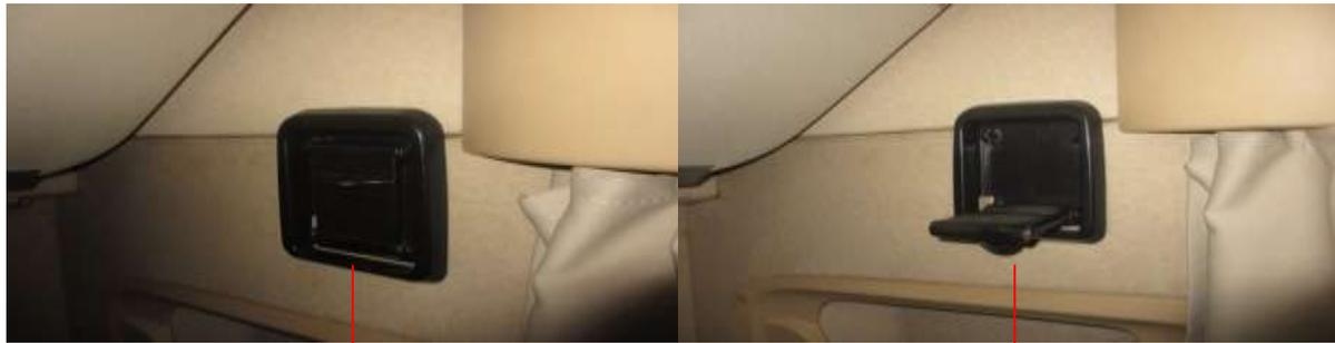
③ Боковой фиксатор в сложенном положении
