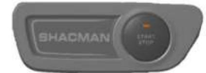
④ Нажатие на кнопку для переключения в режим ON: в режим подачи питания АСС при однократном нажатии на кнопку СТАРТ/СТОП, на кнопке загорится индикатор зеленого цвета, автомобиль переходит к подаче питания в режиме ON (как изображено на рисунке).
