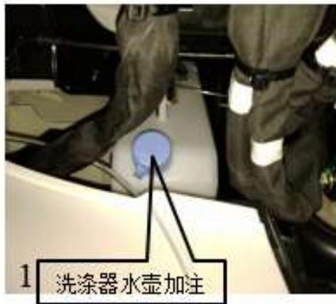
*1 – Отверстие для долива жидкости в бачок стеклоомывателей*
