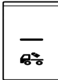
*Переключатель лампы рабочего освещения позади кабины*
