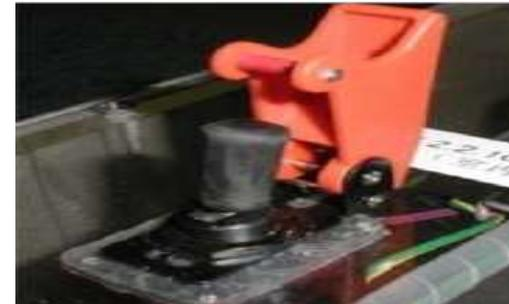
*Переключатель S2/S3 в состоянии экстренного отключения питания*
