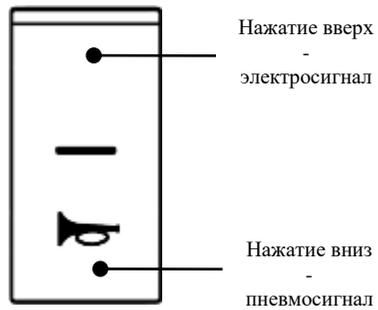
При нажатии на данный переключатель по направлению вниз пневмосигнал переключается в рабочее положение. При нажатии на данный переключатель по направлению вверх электросигнал переключается в рабочее положение.
