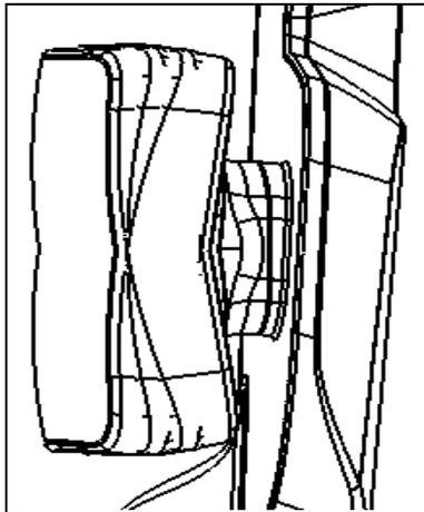
Регулировка положения широкоугольного зеркала осуществляется вручную. Использование широкоугольного зеркала позволяет уменьшить диапазон слепой зоны и повысить угол обзорности из кабины. Водитель может произвести регулировку положения широкоугольного зеркала вручную под индивидуальные параметры.
