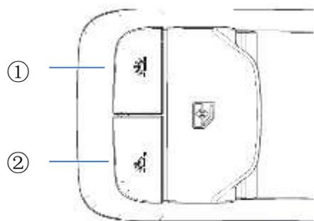
Переключатель ① управляет лампой потолочного освещения кабины, переключатель ② управляет левой лампой для чтения.
