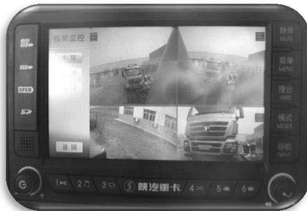
1.3 При выполнении правого поворота дисплей автоматически будет переключен на отображение в полноэкранном режиме данных, полученных с камеры, размещенной с правой стороны автомобиля.
