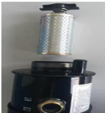
При замене масла системы ГУР следует предварительно слить отработанное масло из рулевого механизма, масляного насоса, масляного бака, масляных шлангов и вспомогательного гидроцилиндра, очистить гидравлическую систему. Заливать чистое масло можно только после того, как система будет очищена от каких-либо загрязнений.
