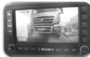
1.2 При включении задней передачи дисплей автоматически будет переключен на отображение в полноэкранном режиме данных, полученных с камеры заднего вида.
