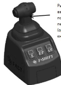
Рычаг применяется для введения запроса на повышение или понижение передачи (одновременно нажать кнопку F)
