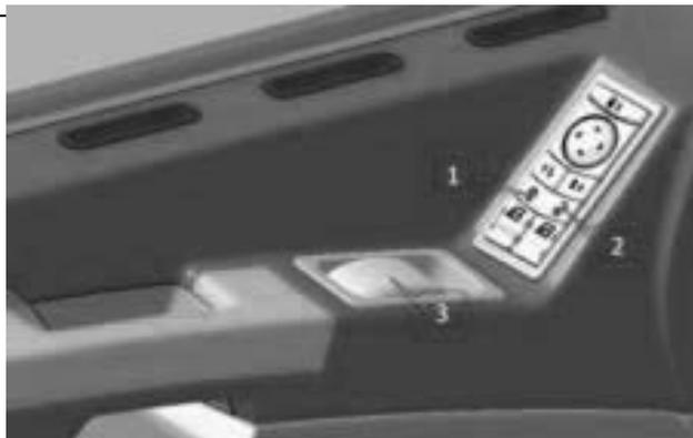
Выполнение операции открывания\закрывания дверей изнутри кабины: для блокировки дверей кабины нажать на кнопку блокировки (1). Перевести кнопку блокировки дверей кабины в положение «разблокировано» (2), потянуть за ручку (3), толкнуть дверь по направлению от себя, дверь кабины будет открыта. На рисунке изображена кнопка управления электростеклоподъемниками двери кабины (опция).
