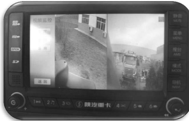
1.4 При выполнении левого поворота дисплей автоматически будет переключен на отображение в полноэкранном режиме данных, полученных с камеры, размещенной с левой стороны автомобиля.
