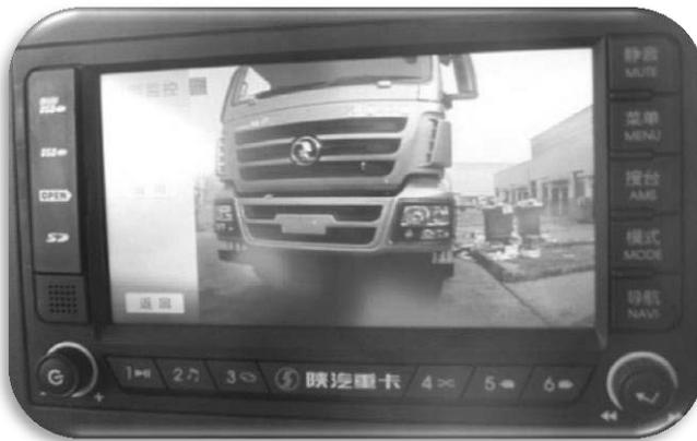
1.3 При выполнении правого поворота дисплей автоматически будет переключен на отображение в полноэкранном режиме данных, полученных с камеры, размещенной с правой стороны автомобиля.
