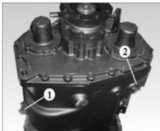
2 - Пробка маслосливного отверстия (вид снизу КПП)
