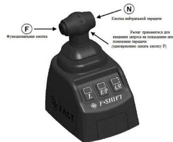
Схематическое изображение модуля рычага переключения передач
