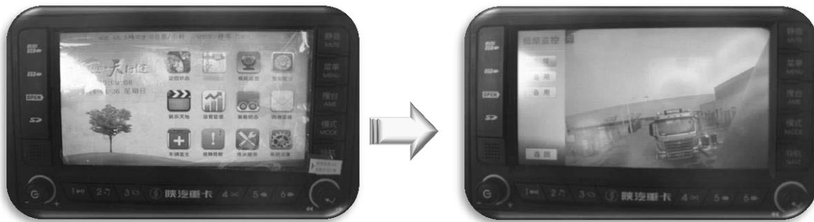
1.2 При включении задней передачи дисплей автоматически будет переключен на отображение в полноэкранном режиме данных, полученных с камеры заднего вида.
