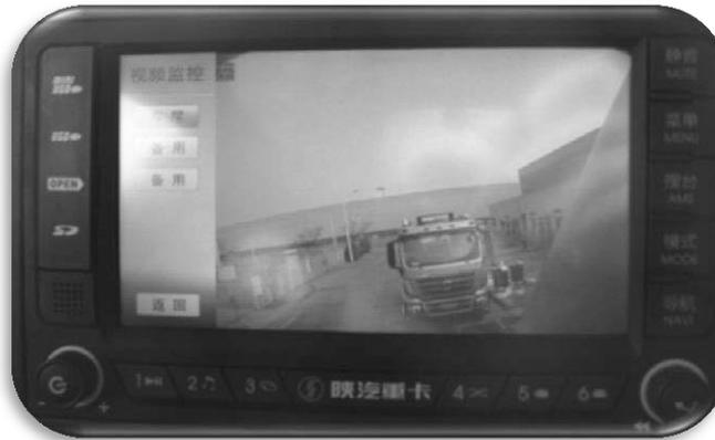
1.5 Каждая из вышеизложенных операций от начала до конца сопровождается отображением данных, полученных с парктроников. Отображаемая информация включает в себя только данные о расстоянии до препятствия. Если расстояние до препятствия в пределах 2 метров на дисплее начинают отображаться данные, полученные с парктроников.
