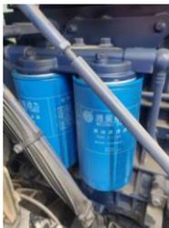
При каждом ТО производить очистку
