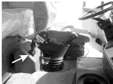
Пружинный тормоз разрешается отпустить только после того, как давление в тормозной системе достигнет уровня выше 0.55 МПа (5.5 Бар) и сигнальный индикатор стояночного тормоза погаснет.
