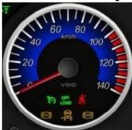
Спидометр получает сигнал от датчика скорости, расположенного на выходном фланце КПП, после чего приводится в действие шаговый двигатель, который осуществляет индикацию.
