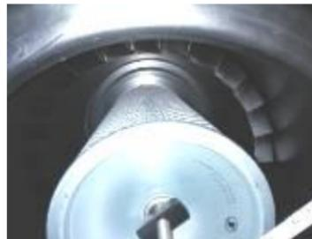
Предохранительный фильтрующий элемент
