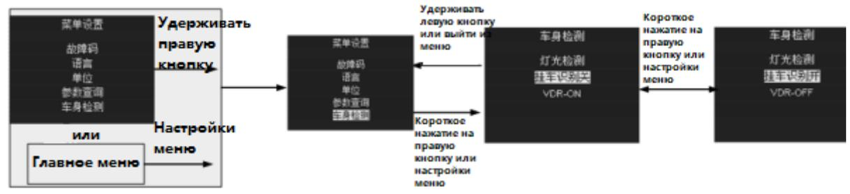
Выбрать пункт меню «Включение распознавания прицепа», включить левый указатель поворота, при этом на комбинации приборов отобразится LED индикатор прицепа, как показано на рисунке ниже:
