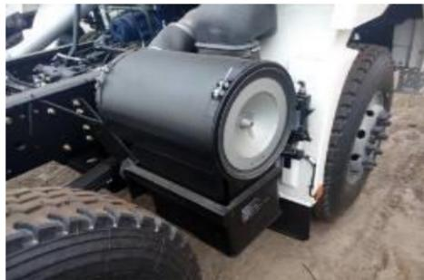
фильтр не заливается. При вводе автомобиля в эксплуатацию необходимо залить 4 литра моторного масла, той же вязкости, что используется в двигателе в данный период.
