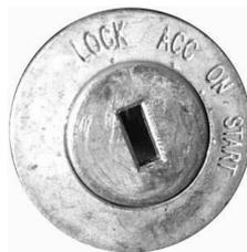
Вставить ключ в отверстие замка зажигания, повернуть ключ в положение «ON», электронный блок управления (ECU) подключится к источнику питания, на комбинации приборов должны загореться три сигнальных индикатора. Система подключена и осуществляет самодиагностику.
