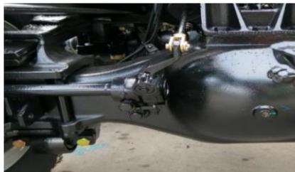
При условии исправности рычага автоматической регулировки зазоров тормозных механизмов, необходимость регулировки вручную отсутствует. Необходимо регулярно производить обслуживание и проверку регулировочного рычага на предмет
