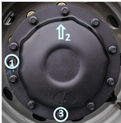
смазку не требуется. Данный узел является необслуживаемым на протяжении 500 000 километров пробега. При этом на ступице будет нанесена соответствующая маркировка.
