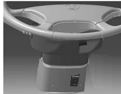
положение руля. После того, как регулировка будет завершена, нажать на верхнюю часть клавиши регулировки руля, положение руля будет зафиксировано.
