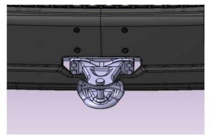
(4) После использования буксировочного устройства выполните описанные выше действия в обратном порядке, чтобы снять его, затем очистите болты и гайки и положите их в боковой ящик для инструментов для следующего использования.
