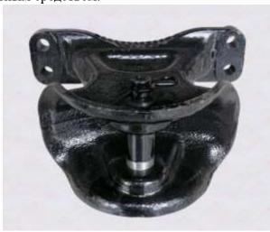
Переднее буксировочное устройство поставляется вместе с автомобилем (используется только по назначению, после его использования его необходимо разобрать и положить обратно в ящик для инструментов):
